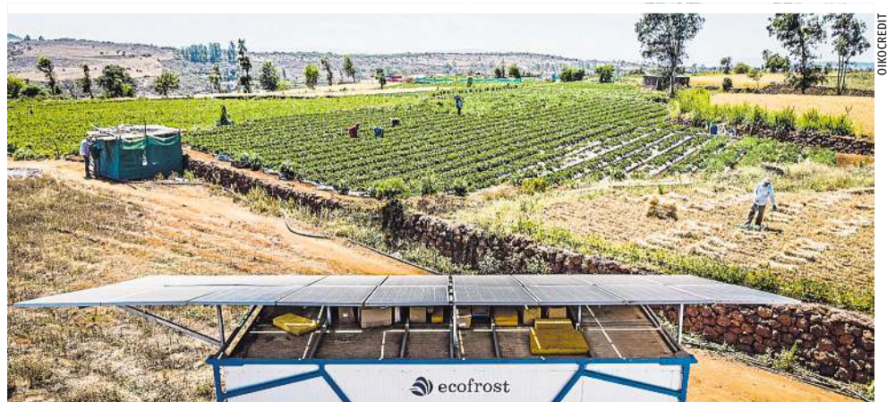
Der solarbetriebene Minispeicher für Obst und Gemüse sorgt dafür, dass die indischen Bauern ihre Ernte bis zum Verkauf frisch halten können
